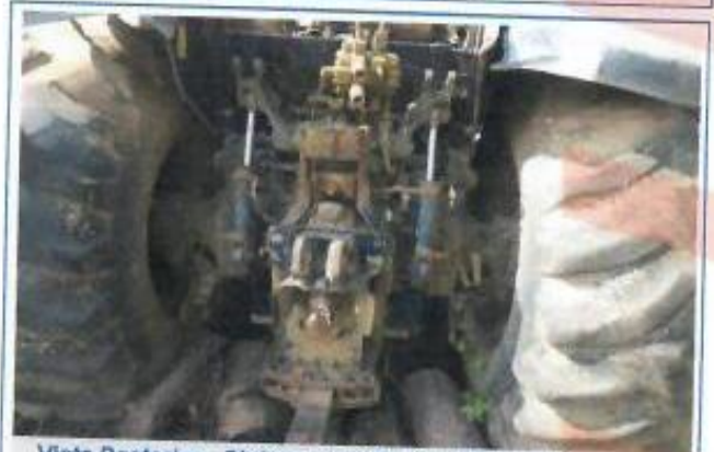
Vista Posterior - Sistema de 3 Puntos (Toma Fuerza con Plataforma - Sist. hidráulico Control Remoto)
